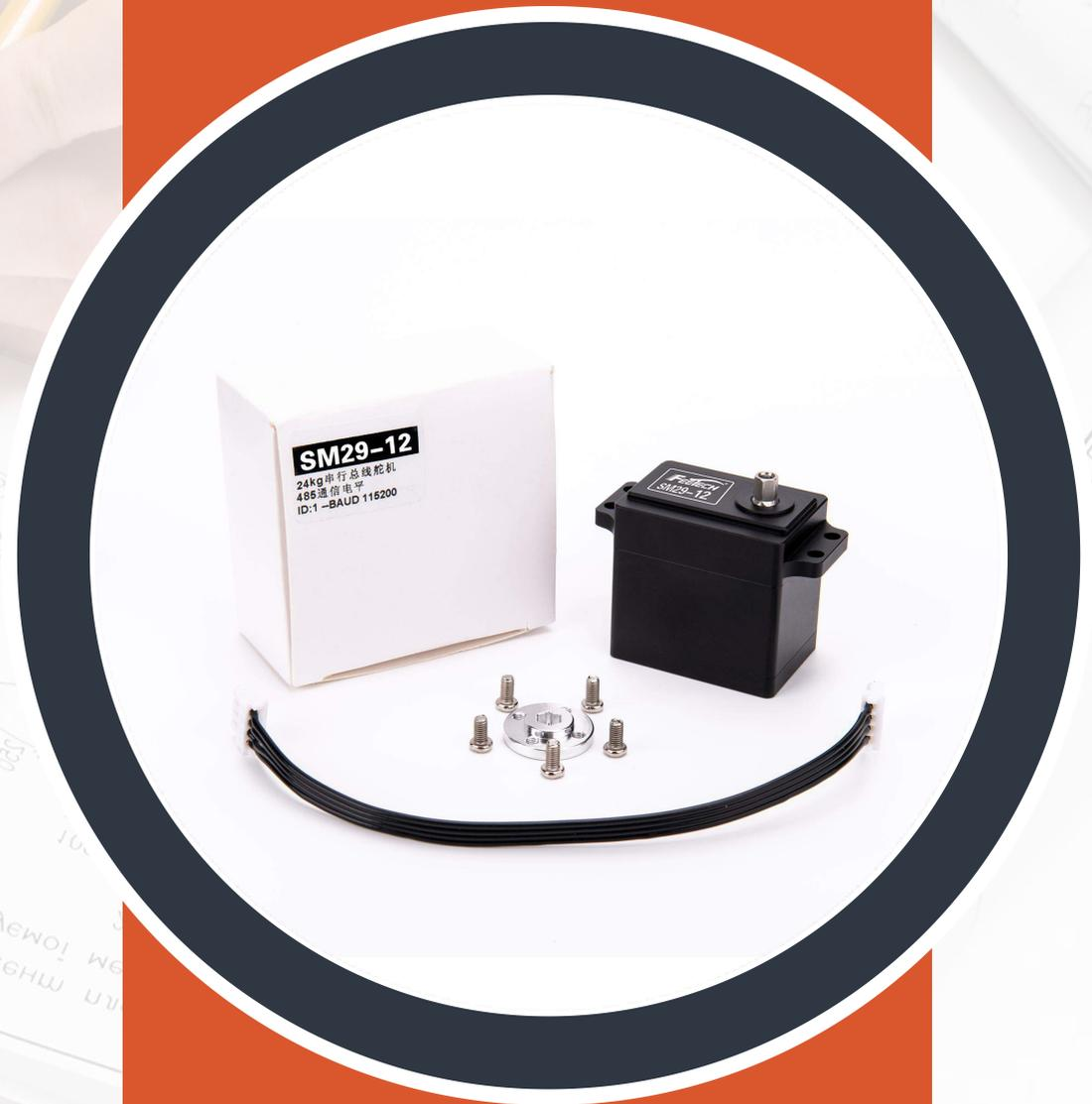
SM29-12是一款12V 24Kg.cm单轴无刷微型智能总线伺服电机。产品特点：高性能可控、小体积、加厚全钢齿轮组、高寿命。广泛应用于工业物流控制体系。产品系列中：输出头有6T/25T，电压：12V/24V，协议：SMS协议/Modbus RTU协议可选。
